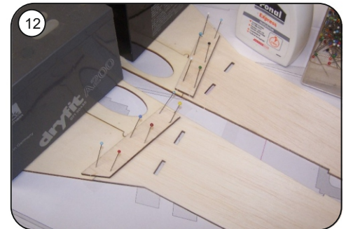
11 Verstärkungen R4 auf die Rumpffinnenseite der Stosskante von R1-R2 und R3 kleben, dabei mit Gewichten und Nadeln fixieren. An Ober- und Unterkante jeweils etwa 4mm Spalt für die später aufzuleimenden Balsaleisten 4x4mm lassen.
