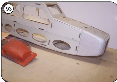
Gersanten Rumpf sauber verschleifen, dabei die Kanten verrunden.
