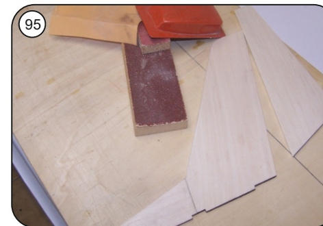
Seitenleitwerk sauber verschleifen dabei die Vorderkanten verrunden (s. Bauplan).
