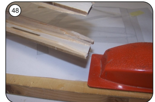
48 Balsaleisten am Rumpffende schräg verschleifen, Schnitt s. Bauplan.
