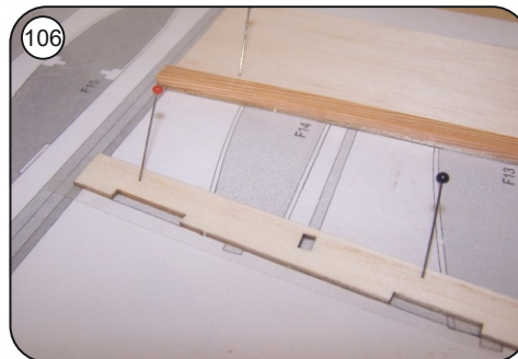
105 Holmgurt an der Hinterkante von F1 bündig auf die Beplankung F1 aufkleben.
