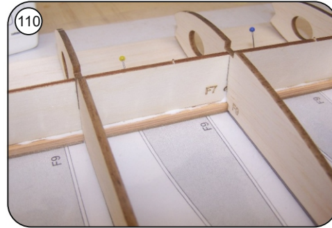
110 Holmgurt auf der gesamten Restlänge satt mit Holzleim einstreichen, Kammholzverlängerung an der Stossrippe einsetzen und die restlichen Rippen F9 einkleben.
