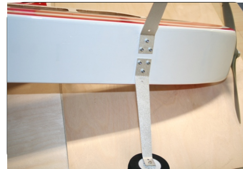
Fahrwerk komplett montiert
