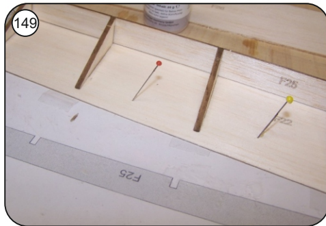
149 Vordere Anschlagleiste F25 mit Sekundenkleber an die Rippensegmente ankleben.
