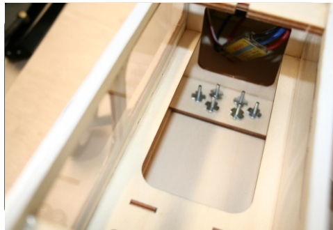
Einschlagmuttern in den Rumpf einsetzen
