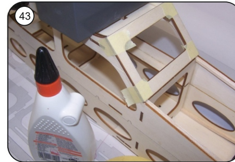
43 Frontscheibenrahmen R26 an der Oberkante bündig ankleben und mit Kreppstreifen sichern.
