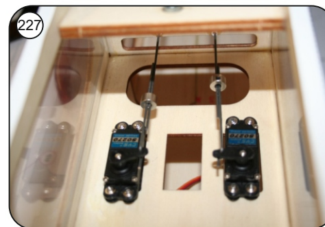
227 Z-Gestänge für die Servoanschlüsse herstellen, in die Servoarme einhängen und mit Stellringen mit den Ruderanlenkungen verbinden. Bowdenzugrohr im Spantendurchgang mit Epoxy sichern.
