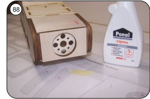
Nasenfüllklotz R37 an den Rumpfkopf ankleben.
