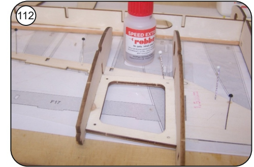
112 Servomontagebrett F12 in die Rippen F11 und F12 einkleben.
