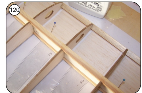
120 Von der Innenseite nachträglich mit Holzleim vermuffen.
