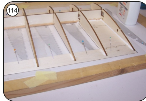
114 Alle Klebestellen nachträglich mit Holzleim vermuffen.
