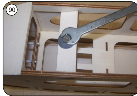
Zm Einbau der Einschlagmutter für die Tragflächenverschraubung diese mit einer passenden Gewindeschraube (M6) und Unterlegscheiben in den Holzsteg R16/R17 einziehen und von der Unterseite mit Epoxy sichern.
