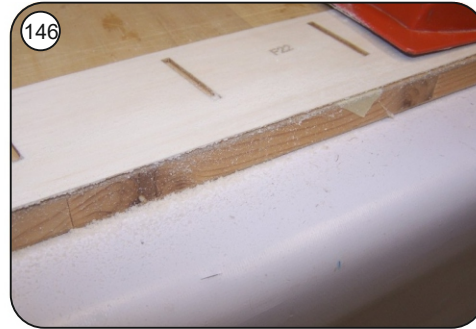
146 Hinterkante der unteren Querruderbepl. ( F22 ) schräg anschleifen.
