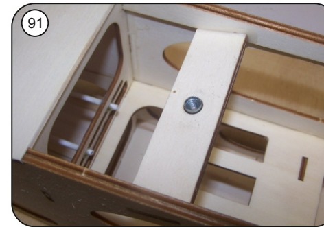
Zm Einbau der Einschlagmutter für die Tragflächenverschraubung diese mit einer passenden Gewindeschraube (M6) und Unterlegscheiben in den Holzsteg R16/R17 einziehen und von der Unterseite mit Epoxy sichern.
