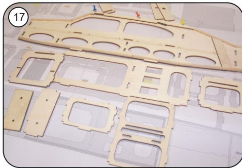
17 Rumpfspanten nach Bauplan selektieren und zuordnen.
