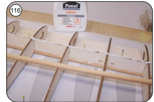
115 Oberen Holmgurt Kiefer 8x3mm auf Länge zuschneiden und mit Holzleim auf dem Kammholm verkleben.
