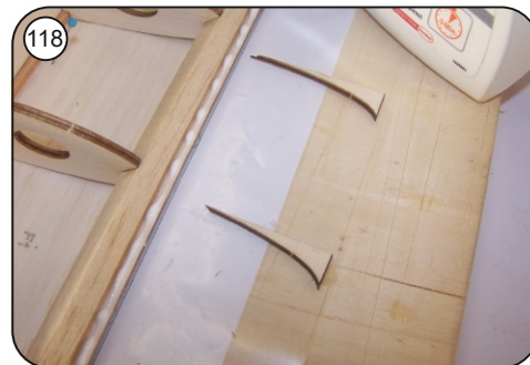
118 Nasenleiste Balsa 8x8mm einkleben, die Vorderkante von Beplankung F1 satt mit Holzleim einstreichen und mit den Formkeilen an jeder Rippe anheben und abstützen, Verbindung Rippen / Beplankung mit Sekundenkleber anheften.
