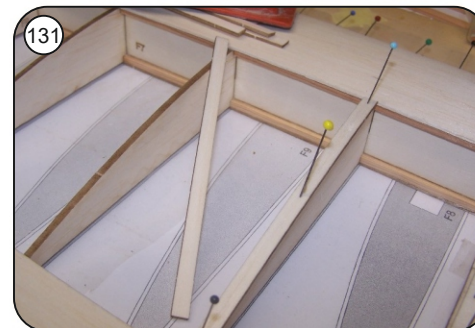
131 Rippenaufleimer auf der Tragflächenoberseite einpassen und aufleimen.
