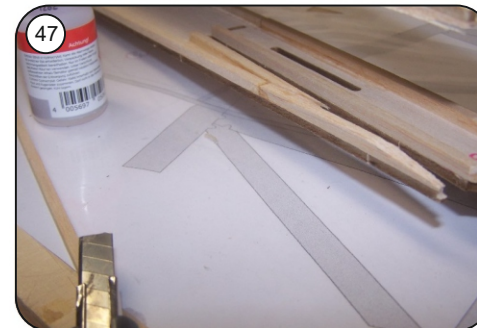
47 Höhenleitwerkstasche oben und unten zusätzlich mit Balsaleisten 4x4mm verstärken.
