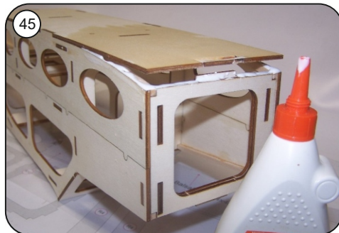
45 Holzleim in den zu verklebenden Bereich einbringen.
