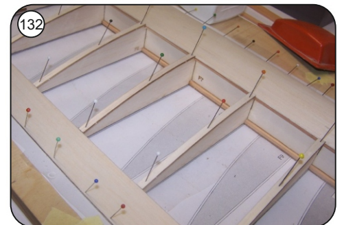
131 Rippenaufleimer auf der Tragflächenoberseite einpassen und aufleimen.
