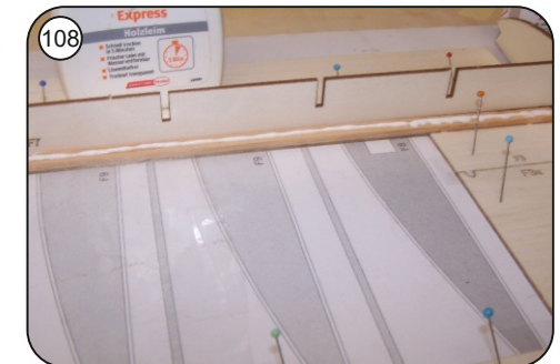
108 Holmgurt in der Länge von Kammholz F7 satt mit Holzleim einstreichen.
